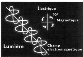
Illustration 12-20. Mouvement d'une onde lumineuse.
