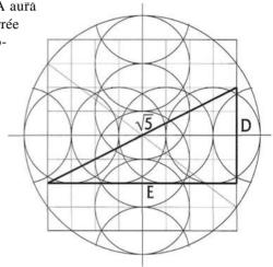
Illustration 9-17b. Autre triangle de la racine carrée de 5 (VF) utilisant *quatre* carrés du treillis au lieu d'un seul égal à 1,0.
